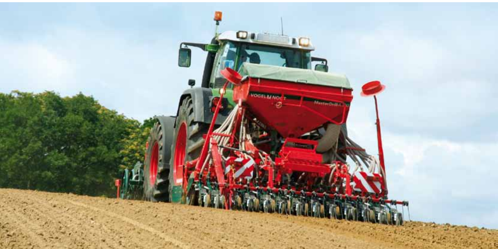
MasterDrill A 300 mit Doppelscheibenscharen und Druckrollen
