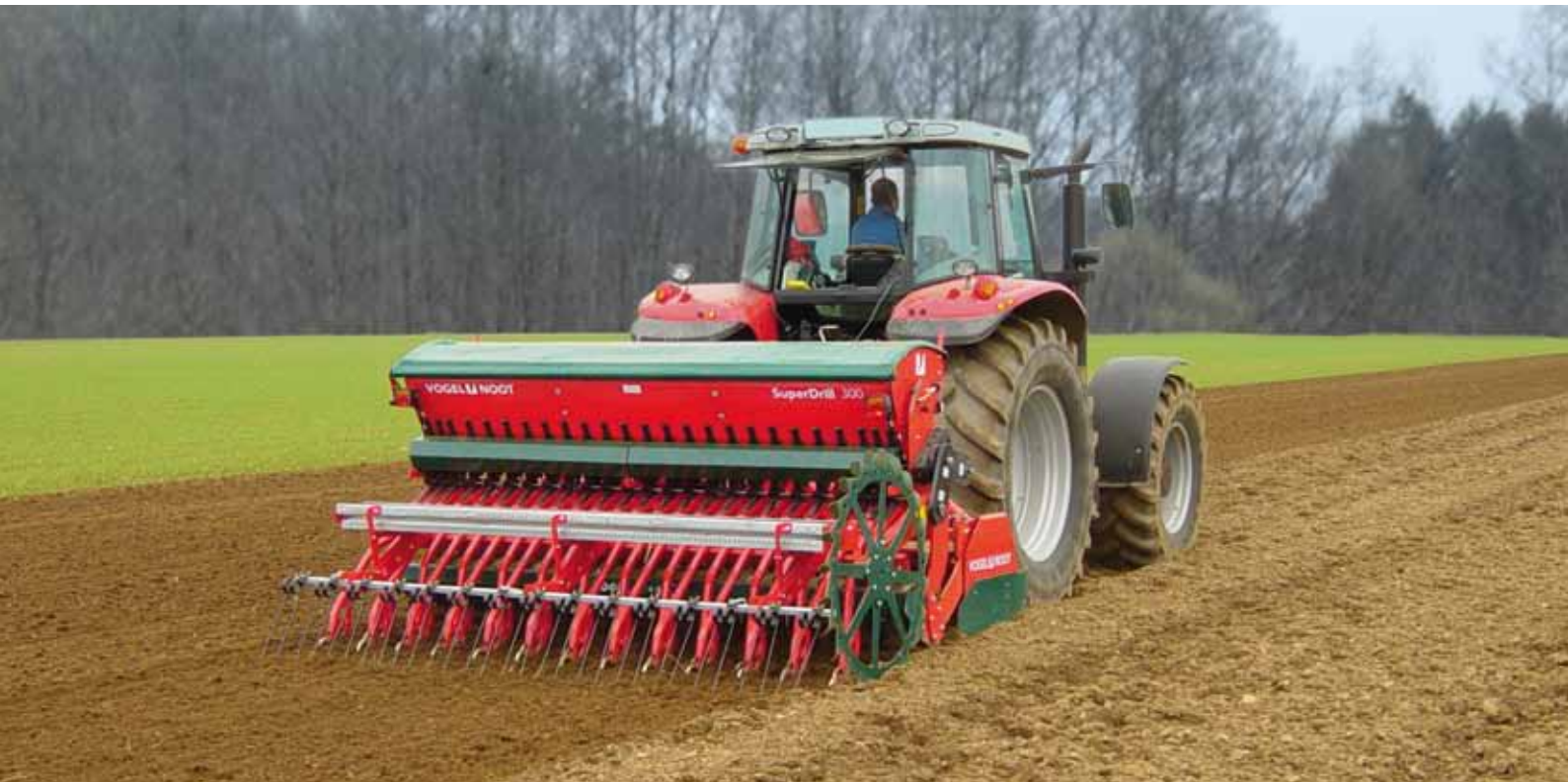
SuperDrill A 300 mit Säbelscharen
