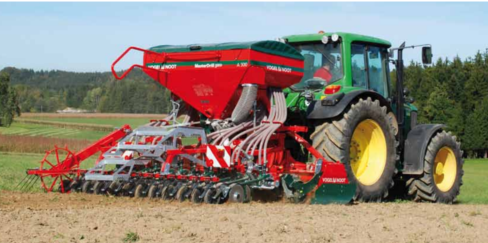
Saatbettbereitung, Rückverfestigung und Aussaat in einem Arbeitsgang
