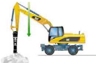
**Hammerarbeiten.** Der Hammer dringt durch sein Eigengewicht ohne zusätzlichen Anpressdruck in das Brechgut ein und schädliche Leerschläge werden vermieden. Ähnliche Vorteile ergeben sich beim Arbeiten mit Verdichterplatten.
