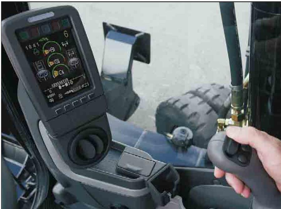
**Anbaugerätsteuerung.** Im Speicher des Monitors können beliebige Volumenstrom- und Druckwerte für bis zu zehn verschiedene Anbaugeräte mit Ein- oder Zweifunktionsfunktion unter eigenen Namen abgelegt werden, sodass umständliche Neueinstellungen nach einem Werkzeugwechsel entfallen. Die programmierten Werte sind jederzeit per Tastendruck abrufbar. Exklusive Cat Schiebeschalter in den Joysticks ermöglichen eine feinfühlig proportionale Ansteuerung.
