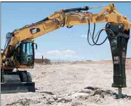
**Konstruktion.** Ausleger und Stiele sind als groß dimensionierte, geschweißte Kastenprofile aus dicken Stahlblechen mit Verstärkungen in den hochbelasteten Zonen gefertigt und bieten daher eine überragende Verwindungssteifigkeit und Dauerfestigkeit.
