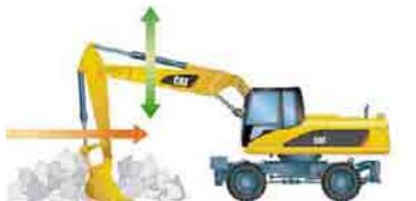
**Steinschürfen/Feinplanieren.** Arbeiten wie Steinschürfen und Feinplanieren werden durch SmartBoom wesentlich erleichtert, denn der Ausleger kann der Bodenkontur frei folgen.
