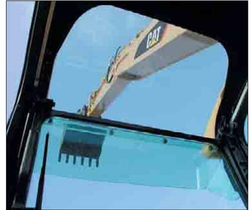
**Kabinenfenster.** Um die bestmögliche Rundumsicht zu erzielen, sind alle Glasscheiben direkt mit der Fahrerkabine verklebt, sodass sichtbehindernde Rahmen entfallen können.
