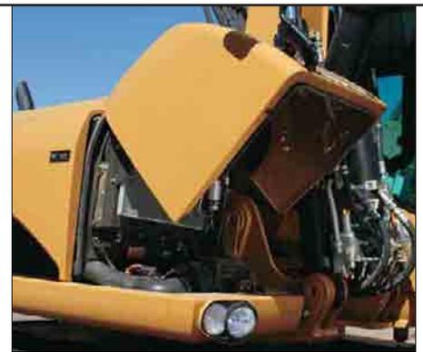
**Zugang.** Bei den Mobilbaggern der Serie D wurde die Instandhaltung noch weiter vereinfacht. Unter anderem sorgen große Oberwagenklappen, die sich mit Gasfeder-Unterstützung mühelos hochschwenken lassen, für freien Zugang zu den wichtigsten Wartungsstellen.
