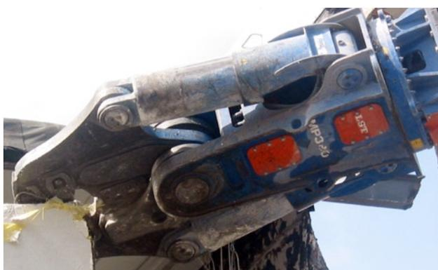
Durch die einfach auswechselbaren Scherenarme (»Kits«) können alle Aufgaben einer Abbruchzange, eines Pulverisierers, einer Schrott- oder Tankschere oder eines Abbruch- und Sortiergreifers bewältigt werden. Durch das spezielle Eilgangventil werden hohe Öffnungs- und Schließgeschwindigkeiten erzielt.
