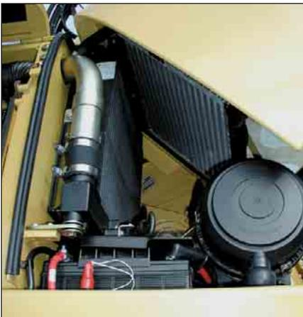
**Leistung/Umweltverträglichkeit.** Im M316C gibt der 3056E ATAAC eine Nennleistung (ISO 9249) von 103 kW (140 PS) bei 2000/min ab. Der Motor unterschreitet die zulässigen Abgasgrenzwerte gemäß 97/68/EG, Stufe II.
