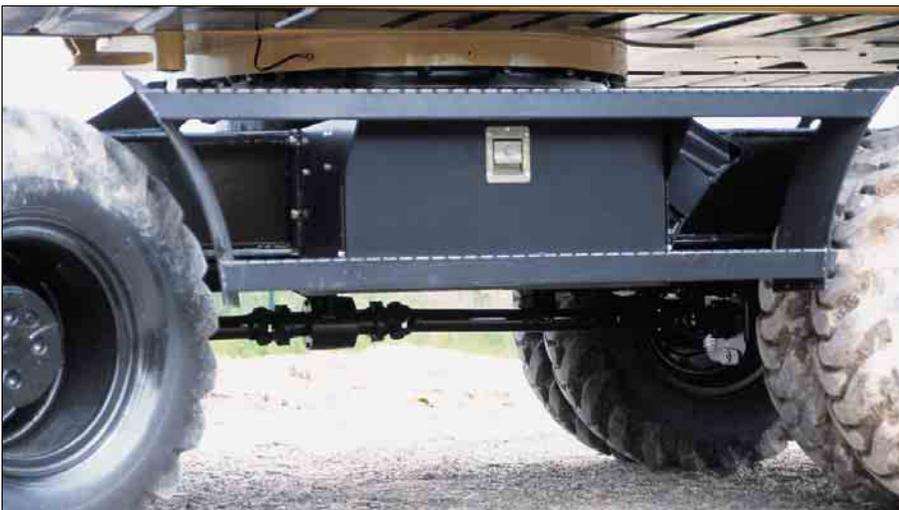
**Abstützpratzen.** Wenn es um höchste Standsicherheit geht, sind Abstützpratzen eine sinnvolle Sonderausrüstung. Dank unabhängiger Steuerung und optimierter Kinematik ist das Nivellieren auf unebenem Untergrund kein Problem. Mittels der praktischen Bolzenbefestigung lassen sich die Pratzen nach Bedarf vorn und/oder hinten anbauen. Im Lieferumfang ist ein stabiler Zylinderschutz enthalten.
