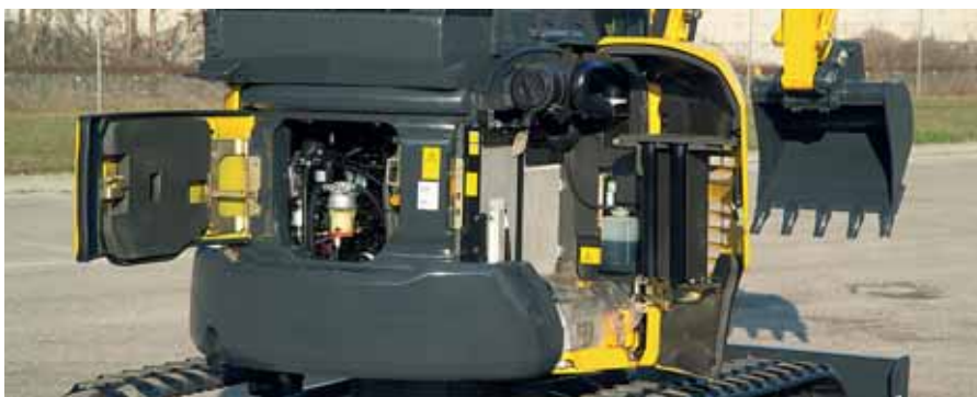
Hinterere Wartungsklappen für schnelle Motorinspektion und Betankung, einfachen Wartungszugang, leichte Reinigung der Kühler und guten Zugang zur Batterie
