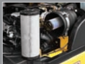
Sostituire il filtro aria, tipo Cyclone da 6"
