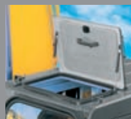
Dachfenster mit Stahlschutz
