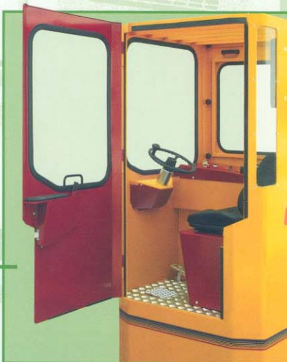
Elektronische Servolenkung. Ausführung mit geschlossener Kabine
