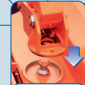
Ein neuartiges Schnellwechselsystem ermöglicht ein stufenloses Drehen um 360° und ein Wechseln des Arbeitswerkzeuges in wenigen Minuten durch eine Person.
