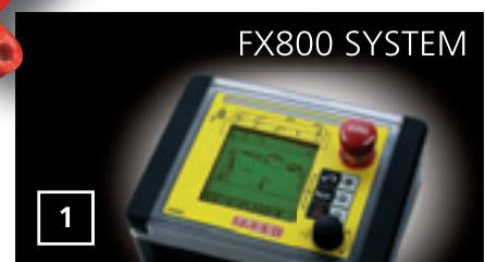
**ES** **1)** Sistema exclusivo FX800 Evolution que controla electrónicamente las condiciones de carga de la grúa, de las extensiones hidráulicas y manuales y del cabrestante, controla el momento de elevación con la posibilidad de activar sectores de trabajo diferenciados, en función de las condiciones de estabilidad de la unidad camión/grúa. Además transmite y registra los datos operativos y señala automáticamente la necesidad de mantenimiento periódico.
