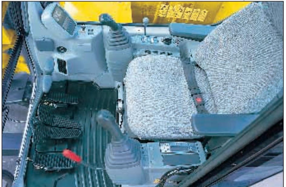
**“High-Space”-Kabine** mit perfekter Rundumsicht durch große Glasflächen und einem transparenten Kabinendach. Extrem niedrige Lärmpegel und perfekte Vibrationsdämpfung.
