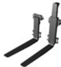
Gabeln mit hydraulischem Niveaueingleich
