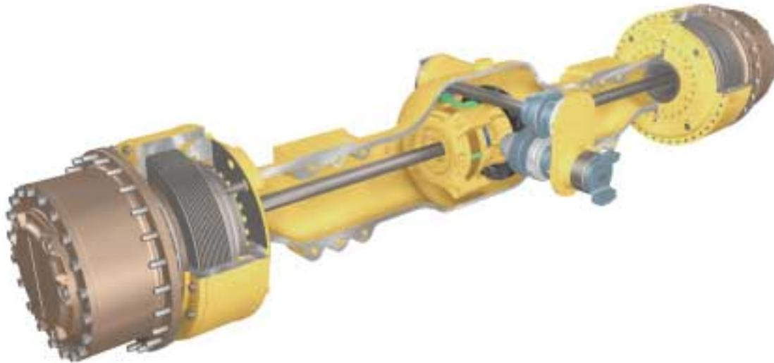
**Differentialsperren.** Alle drei Achsen sind serienmäßig mit sperrbaren Differentialen bestückt, die das Durchdrehen eines Rades pro Achse unterbinden. Hinzu kommt ein Lamellen-Zentraldifferential mit automatischer Drehmomentverteilung zwischen Vorderachse (40%) und hinterer Doppelachse (60%). Bei Bedarf sorgen die Sperren des Zentraldifferentials und der Achsdifferentialen für eine 100%ige Längs- und Quersperre des Antriebs und exzellenten Vortrieb auch bei schwierigen Fahrbahnverhältnissen.
