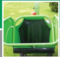
Der Häckselprozess wird von 2 drehbaren Klingen erledigt, die nachgeschärft werden können. Diese sind auf einem Rotor montiert, der mit einer Drehzahl von 2.400 U/min arbeitet und von 2 V-Riemen angetrieben wird.
