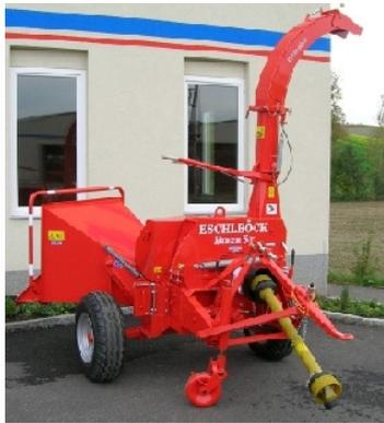
**Biber 5 K:** Kurzhackmaschine zur Erzeugung von exaktem Hackgut für automatische Holzfeuerungsanlagen bzw. für die Kompostierung. Einstellbare Hacklänge von 0,5 bis 2,5 cm Länge.
