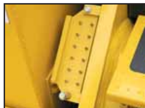
Impianto di lubrificazione centralizzata
