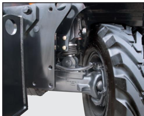
Die hydraulische Federung vorne absorbiert Stöße gut, die während der Fahrt entstehen, sorgt dadurch für Fahrkomfort und verringert die Ermüdung und Belastung des Fahrers.
