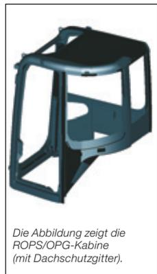
Die Abbildung zeigt die ROPS/OPG-Kabine (mit Dachschutzgitter).
