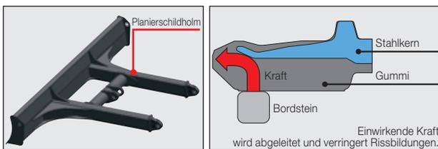
Die Planierschildholme mit Kastenprofil zeichnen sich durch eine hohe Robustheit und Steifigkeit beim Planieren aus. Alle Kettenplatten sind mit Stahlkernen verstärkt. Dadurch sind die Kanten der Kettenplatten beim Überfahren von z.B. Bordsteinen wesentlich belastbarer.
