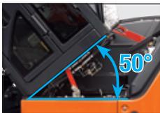
Die Motorabdeckung ist vertikal verschiebbar, damit Kontrollen und Wartungen auch auf engem Raum möglich sind. Der Kabinenboden ist für Arbeiten unter der Kabine und im hinteren Motorbereich um bis zu 50° nach vorn kippbar. Gewellte Lamellen des Kühlers und Ölkühlers verhindern ein Zusetzen mit Staub und sind einfach zu reinigen.
