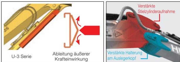
Die Auslegerzylinder-Schutzplatte weist ein Winkelprofil auf und bietet somit zusätzlichen Schutz. Außerdem sind die Stielzylinderaufnahme sowie die Auslegerkopfhalterung verstärkt.
