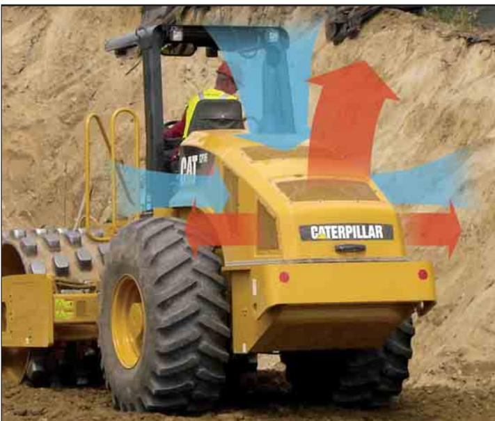
**Kühlluftführung.** Gegenüber der Vorgängermaschine wurde die Kühlluftführung nochmals verbessert. Die vom Lüfter durch Siebgitter im Bereich der Motorhaube angesaugte Außenluft strömt durch den Motorraum und tritt am Maschinenheck nach oben aus. Vorteile des Systems: Der Fahrer wird nicht mehr durch den Warmluftstrom belastigt, und es entstehen kaum noch Staubwirbel auf der Verdichtungsfläche.
