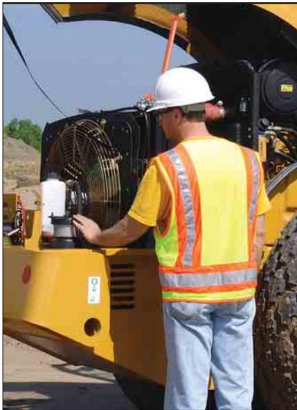
*Die einteilige Motorhaube aus glasfaserverstärktem Kunststoff lässt sich mit Gasfederunterstützung nach vorn hochkippen und erlaubt daher den freien Zugriff auf Dieselmotor und Kühlsystem. Alle Wartungsstellen sind an einer Motorseite zusammengefasst und vom Boden aus erreichbar.*
