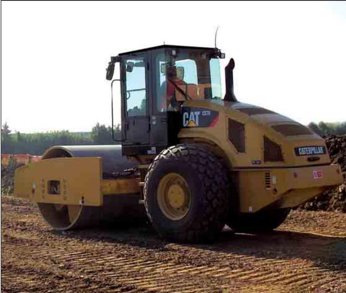
**Traktion.** Zum hydrostatischen Fahrtrieb gehören getrennte Axialkolben-Verstellpumpen für vorderen und hinteren Fahrkreis. Auch beim Durchdrehen von Bandage oder Hinterrädern steht immer ein ausreichender Volumenstrom für den Fahrmotor mit der momentan besten Traktion zur Verfügung, sodass der Vortrieb erhalten bleibt.
