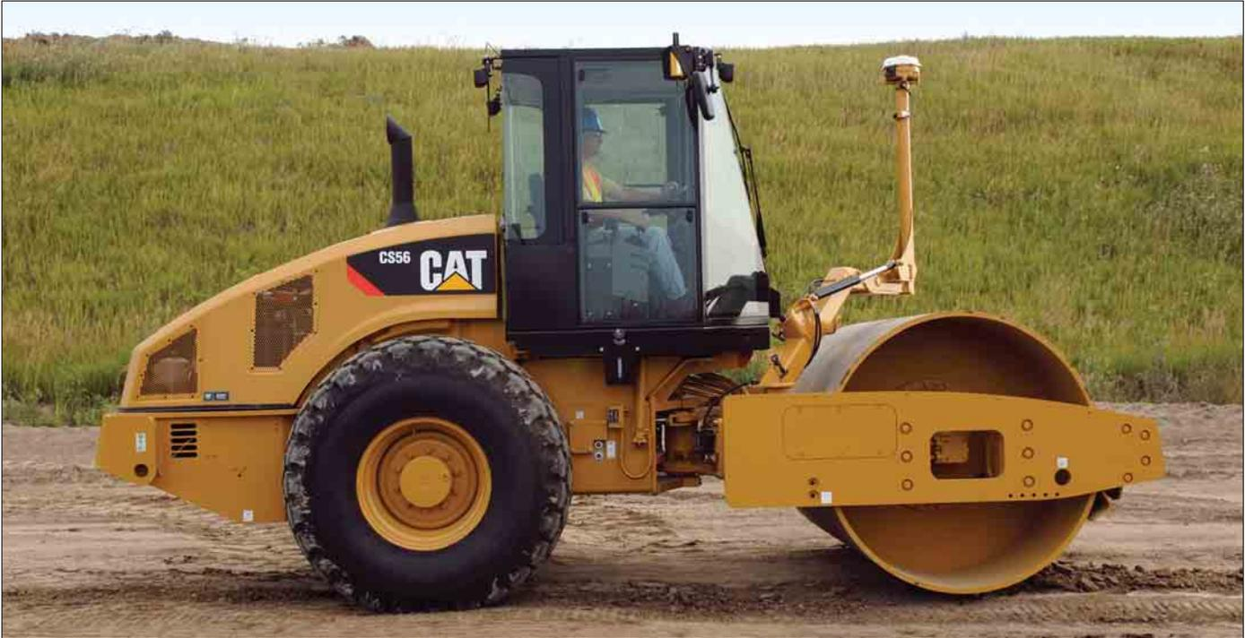
Das Foto zeigt AccuGrade Compaction an einem Walzenzug CS56
