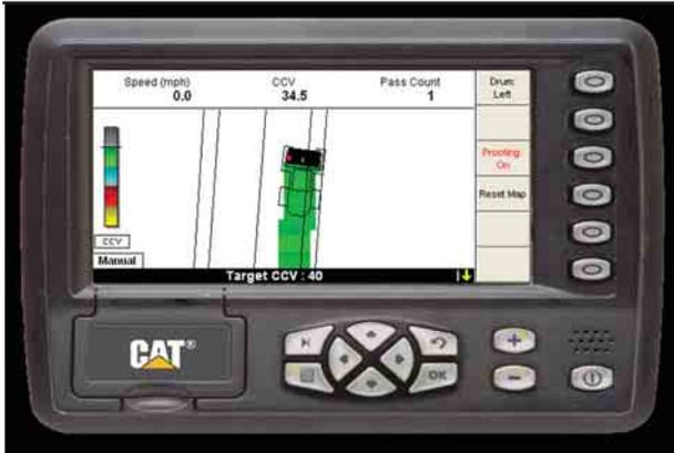
Das Display der Bedien- und Kontrolleinheit informiert den Walzenfahrer über den aktuellen Verdichtungsgrad
