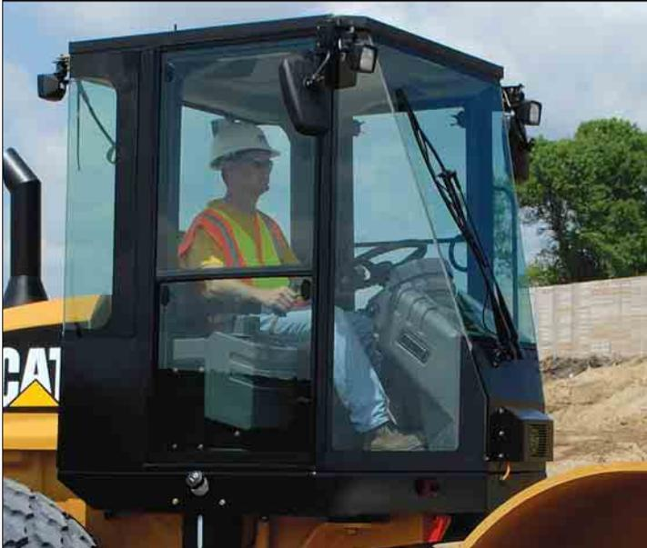
**Innenraum.** Im großen Innenraum findet der Fahrer einen komfortablen, ergonomischen Arbeitsplatz vor. Als besondere Merkmale sind gute Sichtverhältnisse, niedriger Geräuschpegel und diverse Ablagemöglichkeiten hervorzuheben.
