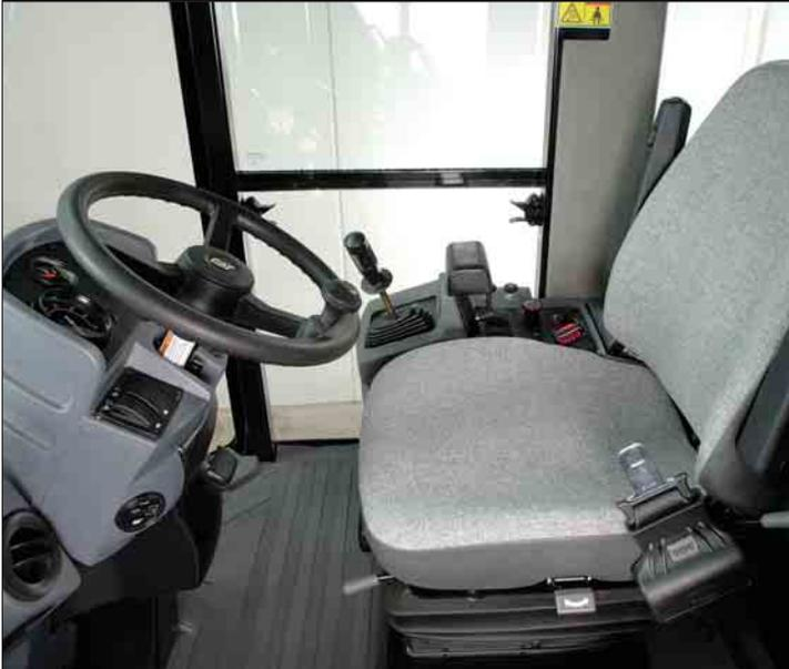
**Instrumentenkonsolle.** Die im Blickfeld des Fahrers angeordnete Instrumentenkonsolle lässt sich zusammen mit der Lenksäule stufenlos verstellen. Dadurch wird das Ein- und Aussteigen erleichtert und eine individuelle Anpassung ermöglicht.
