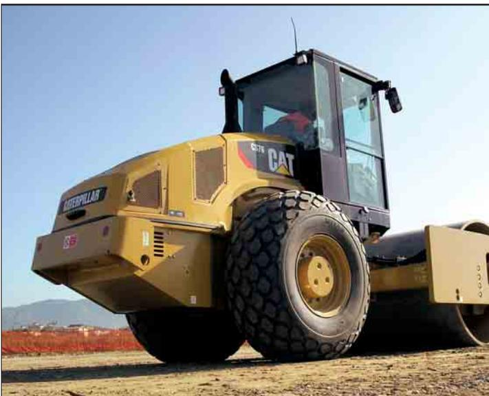
**Sichtverhältnisse.** Aufgrund der starken Abschrägung der attraktiv gestalteten Motorhaube wird die Sicht auf die Hinterräder erheblich verbessert. Gleichzeitig reduzieren sich Höhe und Länge des toten Winkels im Rückraum auf nur noch einen Meter. So lassen sich die Maschinen in der Nähe von Hindernissen erheblich sicherer manövrieren.
