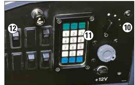
**11 Wägesystem (optional).** Das elektronische Caterpillar Wägesystem ermöglicht ein präzises Wiegen der Schaufelnutzlast während der Fahrt. Die gespeicherten Wiegedaten können auf einen PC heruntergeladen werden.
