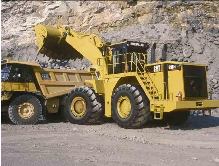
**Teambildung.** Beim Laden aus der Abbauwand geht der 990H mit hoher Produktivität und Wirtschaftlichkeit zu Werke. Die Maschine ist optimal auf die Cat Muldenkipper 773E und 775E mit Nutzlasten bis 65,5 t abgestimmt. In Highlift-Version erweitert sich das Anwendungsgebiet auf den Cat Muldenkipper 777D, der bis zu 94 t Nutzlast bewältigt.
