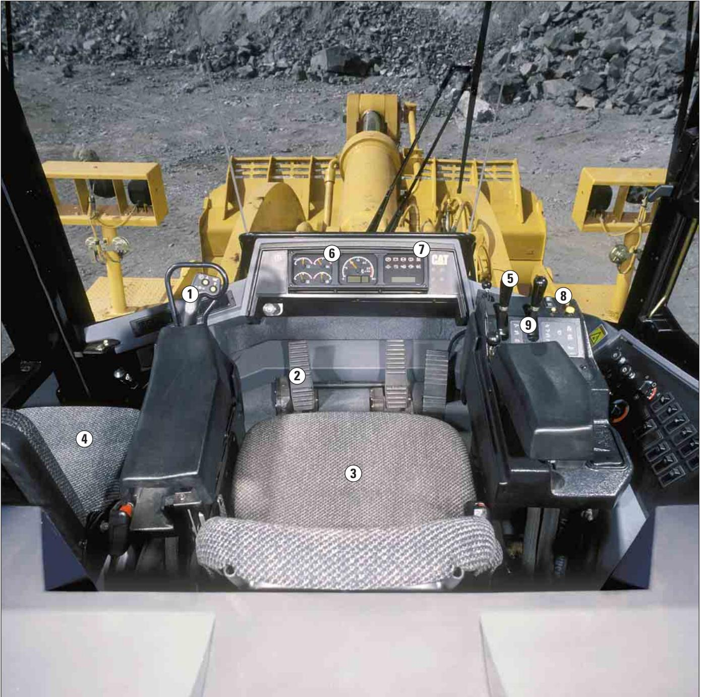
**Ergonomie.** Bei geschlossenen Türen und Fenstern liegt der Schalldruckpegel im Fahrerhaus unter 77 dB(A) gemessen nach ISO 6394:1998. Die großzügige Verglasung bietet freie Sicht nach allen Seiten. Ablagefach, Kleiderhaken, Getränkehalter, Colorglas, Wischwaschanlage mit Intervallschaltung sowie Radiovorrichtung zählen zur Serienausstattung.
