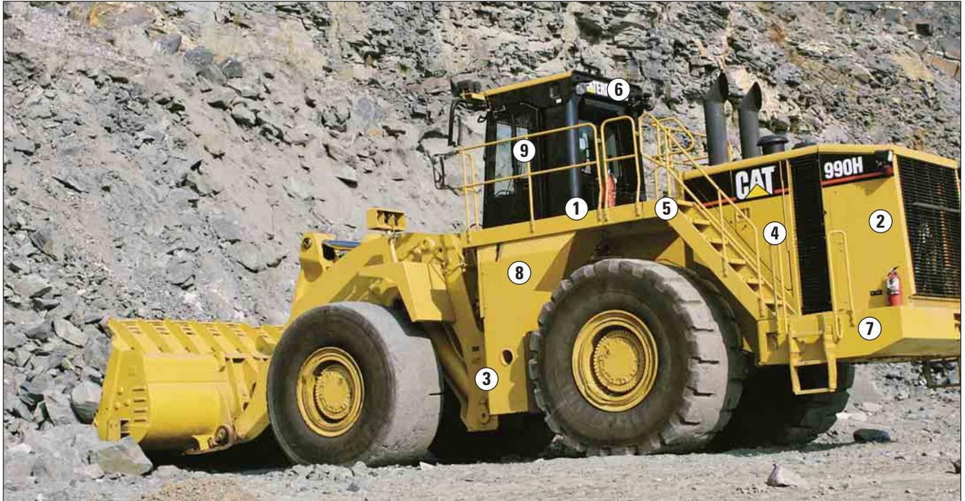
**Instandhaltung.** Ständige Überwachung wichtiger Maschinenfunktionen und Speicherung von Fehlermeldungen erleichtern die Instandhaltung beträchtlich. Mit Laptop und Cat PC-Prüfsoftware Elektroniktechniker kann man das gesamte Bordnetz von einem zentralen Diagnoseanschluss aus überprüfen. Neben der vorbildlich servicefreundlichen Bauweise des Dieselmotors hat der 990H zahlreiche weitere Merkmale zu bieten, die den Instandhaltungsaufwand deutlich reduzieren.
