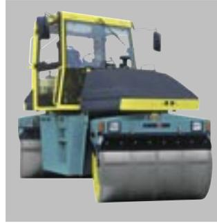
Optimale Sichtverhältnisse dank verschiebbarer Kabine
