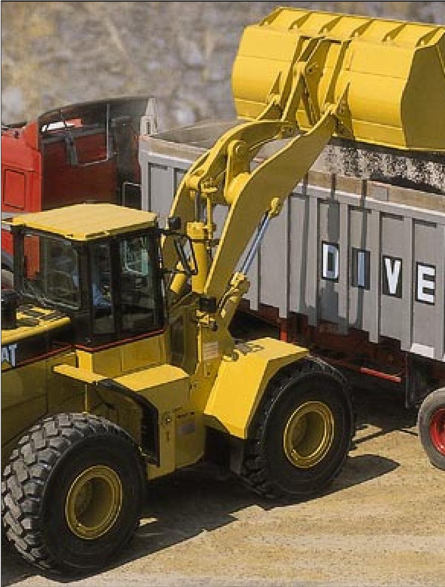
**Richtige Schaufelgrößen.** Die für den 970F lieferbaren Ladeschaufeln wurden auf die Nutzlastwerte der populärsten LKWs und die typischen Schüttgewichte in repräsentativen Gewinnungsbetrieben abgestimmt. Das Angebot umfaßt Erdbauschaufeln mit geradem Schneidmesser und flachem Boden. Diese Schaufelart überzeugt durch hervorragendes Eindringvermögen in losem Haufwerk.
