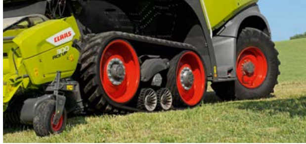
Relevage de l'avant des chenilles en fourrière
