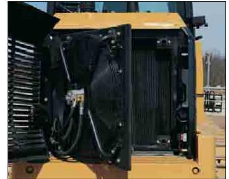
**Kühlsystem.** Kühlerschutzgitter und Lüfter sind schwenkbar ausgeführt, um Reinigungsarbeiten weitgehend zu erleichtern.
