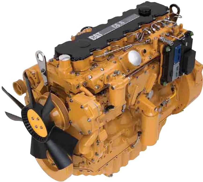
**Konstruktionsmerkmale.** Beim C6.6 handelt es sich um einen Sechszylinder-Reihenmotor mit 6,6 l Hubraum, Cat Common-Rail-Einspritzsystem und ACERT-Konzept, das mittels technischer Innovationen wie fortschrittlicher Elektroniksteuerung, hochpräziser Kraftstoffeinspritzung und optimierter Luftzufuhr für herausragendes Leistungsvermögen und niedrige Abgasemissionen sorgt.
