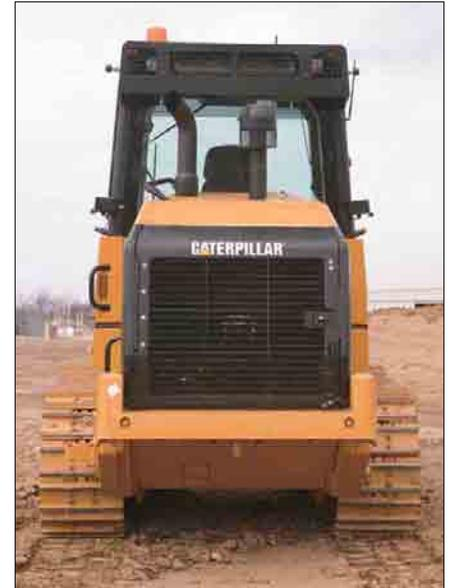
**Dieselmotoranordnung.** Aufgrund der Heckenordnung übernimmt der Dieselmotor die Funktion eines Gegengewichts. Zugleich werden bei dieser Bauform die Sicht auf den vorderen Arbeitsbereich verbessert und die Wartungsarbeiten am Motor erleichtert.
