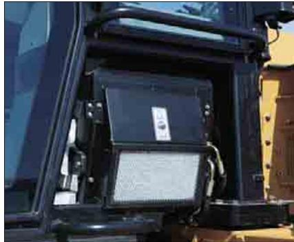
**Linke Kabinenseite.** Unterhalb des linken Kabinenfensters befinden sich Frischluftfilter, Minimeßanschlüsse, Kabinensicherungsstange und Werkzeugkasten.
