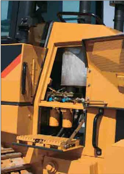
**Linke Maschinenseite.** Hinter der Wartungsklappe an der linken Seite sind die beiden hängend angeordneten, anschraubbaren Hydrauliköl-Wechselfilter zu finden. Der untere Teil der Klappe ist als Trittstufe konstruiert, von der aus Kühlmittel-Ausgleichsbehälter und Ansaugluft-Vorreiniger erreichbar sind.
