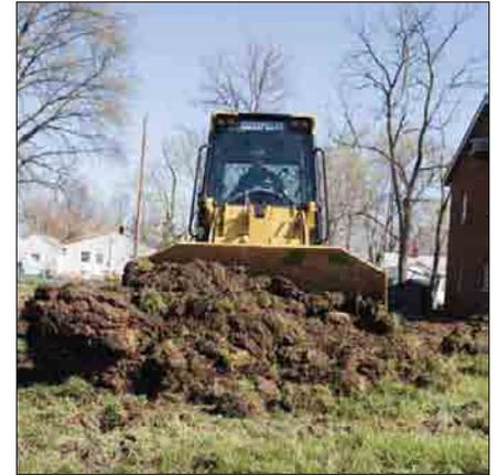
**Lenkung.** Mit dem rechten und linken Pedal wird die Maschine durch individuelles Ansteuern der beiden Laufketten feinfühlig gelenkt. Abhängig vom Betätigungsweg des jeweiligen Pedals fährt der 953D eine mehr oder weniger scharfe Kurve beziehungsweise dreht sich mit gegenläufig angetriebenen Ketten innerhalb der eigenen Länge.
