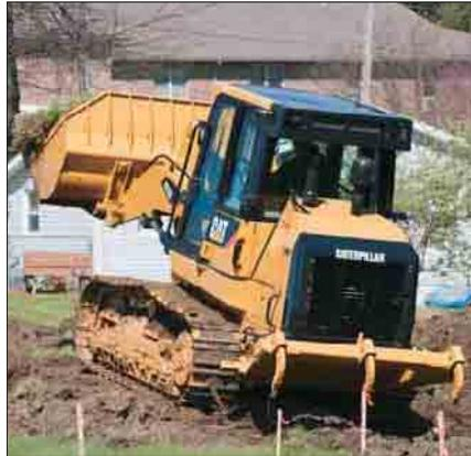
**Pendelung.** Pendelaufhängung mit Drehachse und verbolzte Quertraverse ermöglichen eine vertikale Bewegung beider Laufrollenrahmen. Aufgrund der Rahmenpendelung verbessern sich Fahrerkomfort, Geländegängigkeit und Standsicherheit der Maschine.
