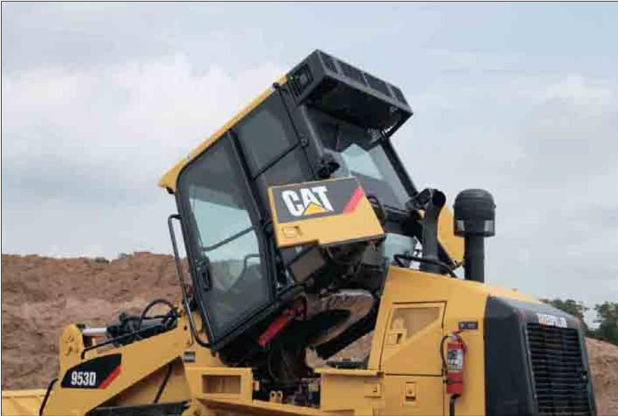
**Kabinenkippvorrichtung.** Eine erhebliche Erleichterung der Wartungs- und Reparaturarbeiten wird durch die kippbare Fahrerkabine erreicht, die in ihrer oberen Endstellung wichtige Komponenten des hydrostatischen Fahrantriebs freigibt.
