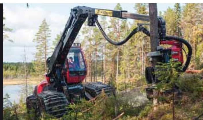
Die Platzierung des Krans in der Mitte der Maschine sowie der Verbund von Tiltzylinbern und Pendelachse sorgen für eine überragende Standsicherheit.
