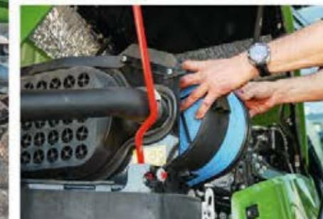
Большой цельный капот упрощает техническое обслуживание в моторном отсеке. Воздушный фильтр удобно обслуживать с подножки.
