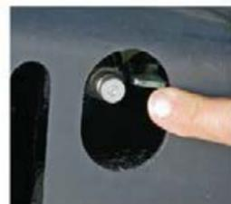
□ Сбоку машины предусмотрен штуцер для удобной регулировки натяжения гусеничных лент.
