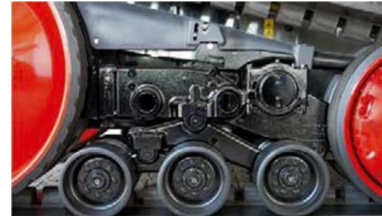
Система Mobil Trac демонстрирует свои преимущества даже на разворотных полосах, где она не создает глубокую колею.
