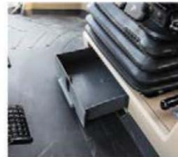
■ Отсек для хранения под сиденьем оператора. Он позволяет поддерживать порядок в кабине.
