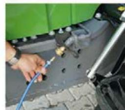
□ В переднюю часть машины вынесли штуцер пневматической системы для очистки радиатора сжатым воздухом.
