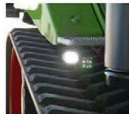
□ Светодиодные световые приборы отлично освещают пространство перед машиной.
