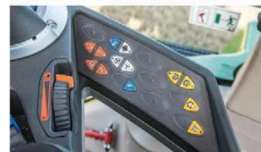
Мембранные клавиши на подлокотнике для настройки параметров работы коробки передач, гидравлической системы и ВОМ.
