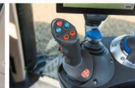
Многофункциональный джойстик для управления скоростью движения, режимами круиз-контроля, частотой вращения коленчатого вала двигателя и системой управления на разворотной полосе.
