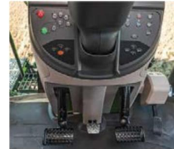
Включение фар и фонарей рабочего освещения при помощи кнопок на левой стороне панели приборов.
