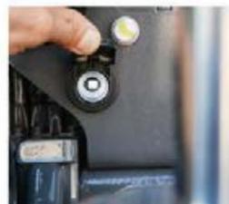
■ Внешние потребители можно подключить к розетке электропитания напряжением 12 В в задней части машины.
