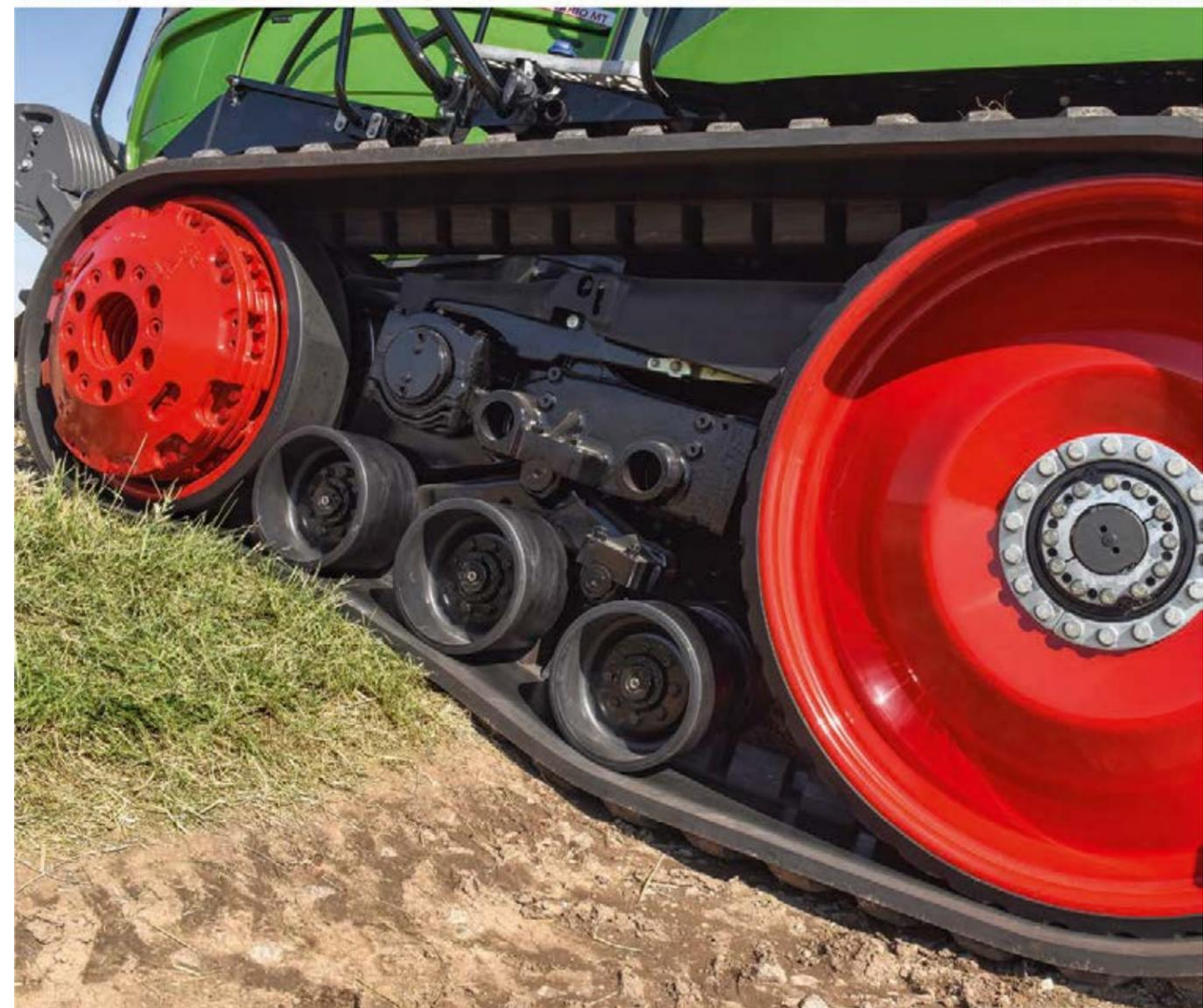
Опорные катки на подвеске прижимаются к поверхности и точно повторяют ее контур. При этом площадь пятна контакта с поверхностью всегда является максимально возможной, а тяговое усилие передается непрерывно.
