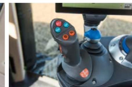
Mit dem Multifunktionsjoystick steuern Sie die Geschwindigkeit, den Tempomaten und Drehzahlsteuer und das Vorgewendemanagement.
