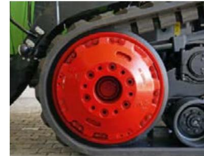
Für beste Kraftübertragung sorgen die hinteren Antriebsräder, die durch Kraftschluss die Laufbänder antreiben.
