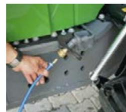
□ An der Maschinenfront befindet sich ein Druckluftanschluss zum ausblasen der Kühler.
