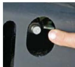
□ Den Druck zur Laufbandvorspannung kann bequem von der Seite per Anschluss angepasst werden.
