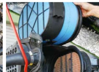
Der Luftfilter ist leicht zu tauschen und besitzt einen Schmutzsensoren, der über die Filterwirkung Auskunft gibt.
