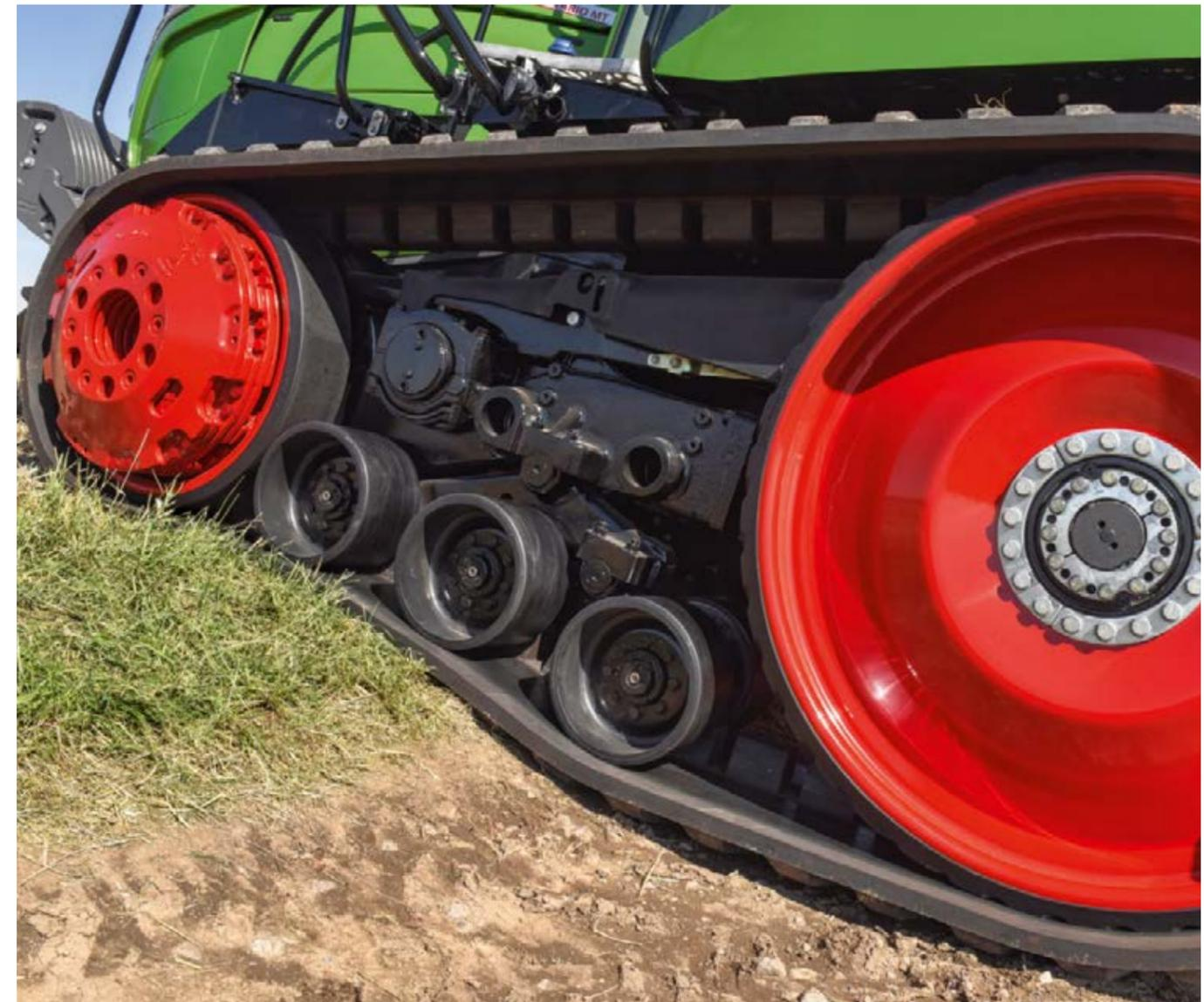
Damit der Bodenkontakt nie abreißt und die Kraft permanent übertragen werden kann, sind die mittleren Laufrollen gefedert und passen sich Bodenkonturen an.
