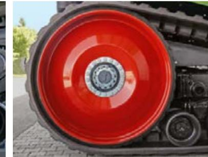
Die robuste Hinterachse ist gebaut für längste Lebensdauer. Der eigene Ölhaushalt kann bequem über Schaugläser kontrolliert werden.
