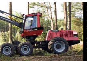
La stabilisation de la cabine et de la grue d'une part, et l'accouplement de celles-ci avec l'essieu oscillant, permettent d'optimiser aussi bien la portée que la stabilité.
