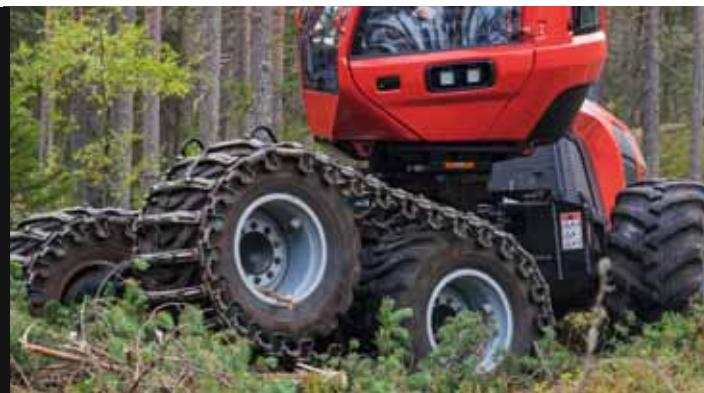
Le bogie portique unique Komatsu Comfort Bogie permet d'excellentes qualités de stabilité, de garde au sol et d'accessibilité.
