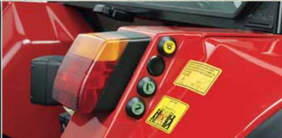
PDF actionnée de manière électrohydraulique et gestion de la PDF\* pour un confort de contrôle encore plus grand.
