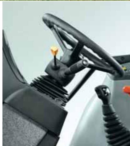
Il vous suffit d'actionner le levier Powershuttle pour changer de direction.
