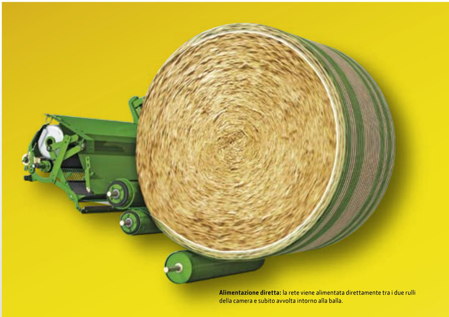
**Alimentazione diretta:** la rete viene alimentata direttamente tra i due rulli della camera e subito avvolta intorno alla palla.
