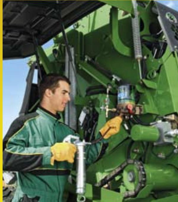
Lubrificazione automatica delle catene: per una maggiore durata utile, produttività più regolare e meno interventi di manutenzione.
