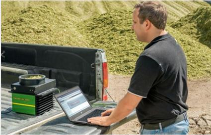
Le capteur HarvestLab 3000 de John Deere peut également être utilisé comme laboratoire dans un bâtiment de stockage ou un bureau. La connexion à la prise de courant d'un véhicule vous permet d'être entièrement mobile et vous fournit des informations instantanées, où que vous soyez.
