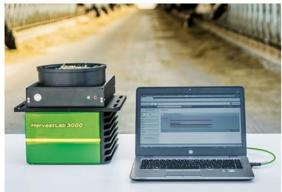
HarvestLab 3000 también es rentable al finalizar las campañas de fertilización y recolección de forraje: Desmontado de la máquina, el sensor puede utilizarse como unidad estacionaria para medir los ingredientes del ensilado de su búnker y optimizar las raciones de alimentación.
