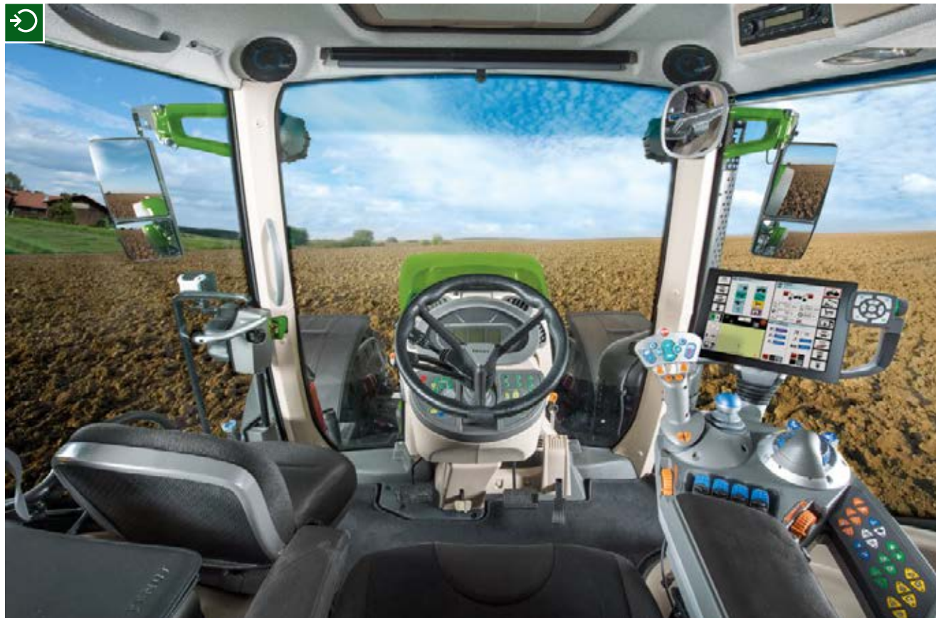
Il 900 Vario è stato progettato per una visibilità ottimale. Il cofano è stato mantenuto il più stretto possibile, in modo che l'operatore abbia una vista eccellente sui passaruota e gli attrezzi frontali.
