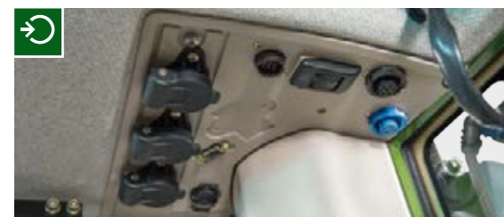
□ Nella cabina sono disponibili numerose prese, anche molte prese da 12 Volt, prese ISOBUS e prese per segnali.
