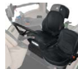
□ Il sedile di massimo comfort dinamico attivo Evolution DualMotion è una tipologia di sedile ad alta tecnologia. Gli operatori traggono vantaggio dalla sospensione attiva aggiuntiva. Il rivestimento del sedile è disponibile in tessuto nero oppure in pelle liscia nera, abbinata al volante rivestito in pelle.
