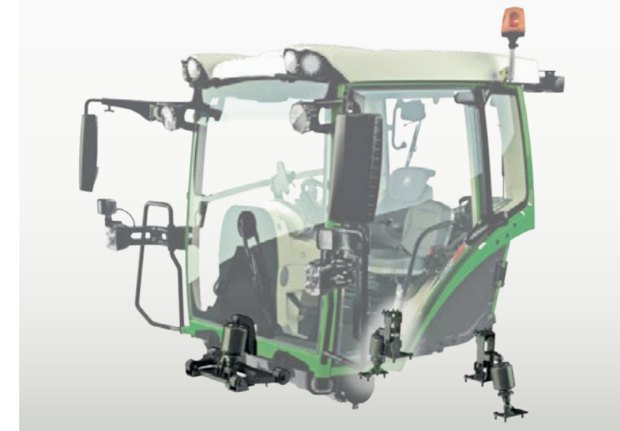
■ La sospensione della cabina su 3 punti con elementi pneumatici consente di ridurre al minimo le vibrazioni interne. La notevole differenza d'altezza e la distanza tra gli elementi della sospensione della cabina X5 impediscono inoltre fenomeni di beccheggio per un comfort di guida di altissimo livello.
