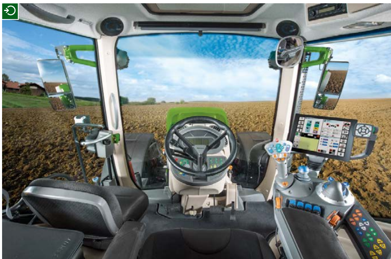
Le Fendt 900 Vario a été perfectionné pour que la visibilité soit optimale. Le capot a été conçu de manière à ce qu'il reste le plus étroit possible pour que le conducteur ait une vue excellente sur les passages de roue et les outils montés à l'avant.
