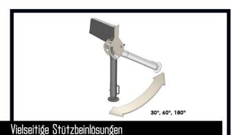
Die Kranstützbeine bieten Standsicherheit, aber gleichzeitig müssen sie auch bedienerfreundlich sein und nur wenig Platz aufnehmen. Deshalb bietet HMF folgende wahlfreie Lösungen: 30/60° manuell schwenkbare Stützbeine oder 180° manuell schwenkbare Stützbeine mit Gasfeder. Sie können frei zwischen einem hydraulisch ausfahrbaren und einem manuell ausziehbaren Auszugskasten wählen, auch wenn der Kran mit dem fortgeschrittenen EVS Standsicherheitsüberwachungssystem ausgerüstet ist.
