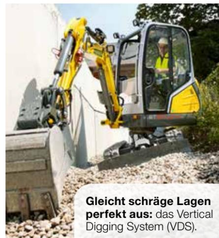
**Gleicht schräge Lagen perfekt aus:** das Vertical Digging System (VDS).
