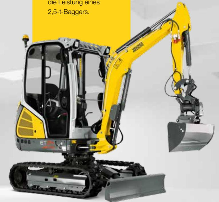
**Leicht und leistungsstark:** kann per Pkw-Anhänger transportiert werden und erbringt die Leistung eines 2,5-t-Baggers.
