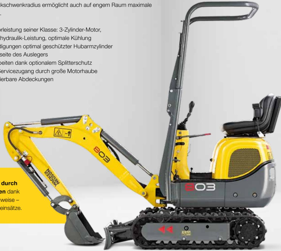
**Passt locker durch Standardtüren** dank schlanker Bauweise – ideal für Inneneinsätze.
