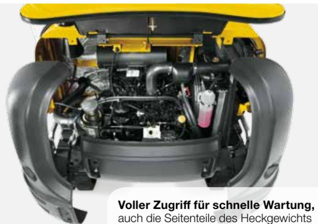
**Voller Zugriff für schnelle Wartung,** auch die Seitenteile des Heckgewichts lassen sich herausziehen.
