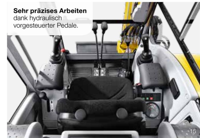
**Sehr präzises Arbeiten** dank hydraulisch vorgesteuerter Pedale.
