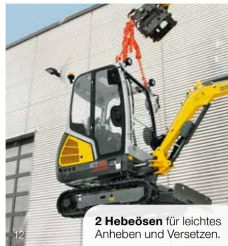
**2 Hebeösen** für leichtes Anheben und Versetzen.
