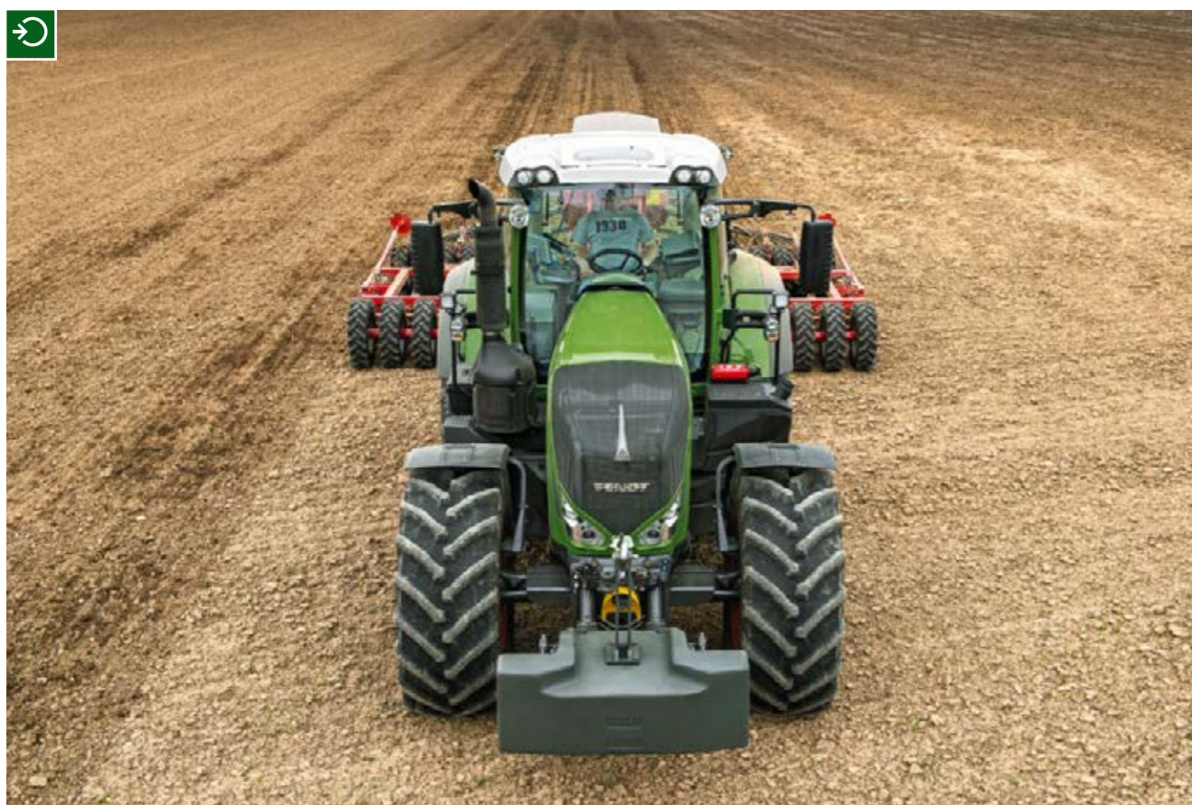
Le Fendt 800 Vario a été perfectionné pour que la visibilité soit optimale. Le capot a été conçu de manière à ce qu'il reste le plus étroit possible pour que le conducteur ait une vue excellente sur les passages de roue et les outils montés à l'avant.
