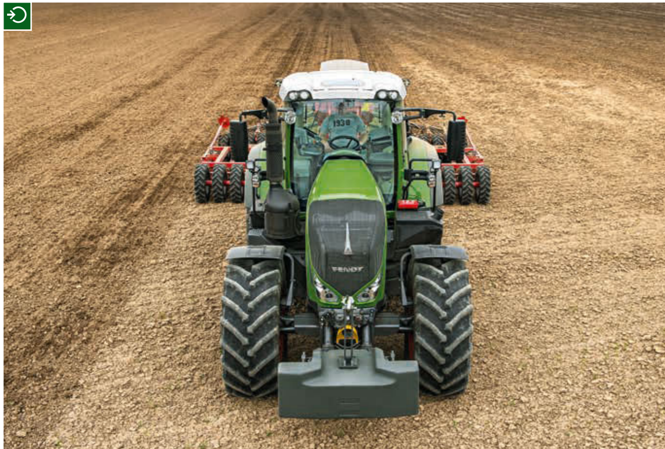
Der Fendt 800 Vario ist auf optimale Übersicht getrimmt. Die Haube ist möglichst schlank gehalten, so dass der Fahrer eine sehr gute Sicht auf den Radlauf und Frontgeräte hat.
