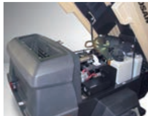
Die weit öffnende Haube gewährleistet guten Zugang zu den Wartungspunkten
