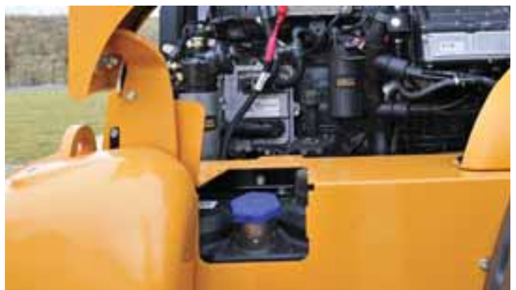
AdBlue muss nur alle drei Kraftstofffüllungen nachgefüllt werden.
