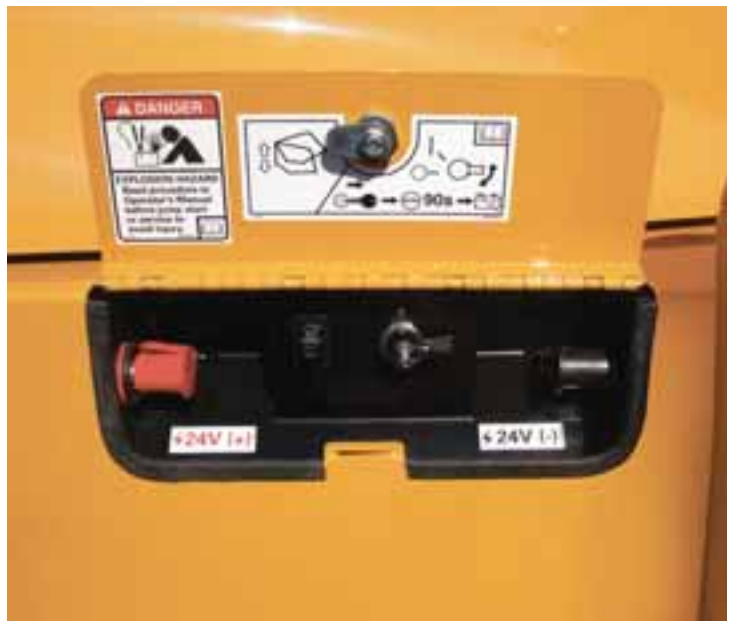
Haubenöffnungs- sowie Batterie-Ein/-Aus-Schalter. Wenn die Batterie leer ist, kann die Haube über eine extreme Starthilfe geöffnet werden.
