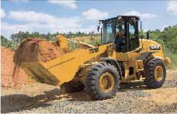
Progettate per un'ergonomia ottimale, le pale gommate Case sono dotate di sistema antibeccheggio "Ride Control" per permettere la flottazione dei bracci di sollevamento durante il trasporto, in modo da evitare contraccolpi alla cabina e alle ruote. Il Ride Control consente di raggiungere velocità più elevate durante le operazioni di movimentazione, assicurando un'eccellente ritenzione del carico e riducendo la fatica dell'operatore.
