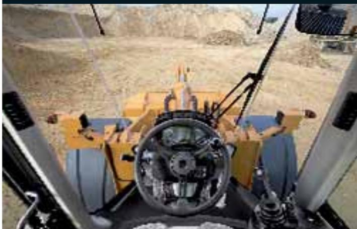
Rispetto alle pale Serie D (721) o Serie C (821), i modelli 721E e 821E offrono il vantaggio di una cabina ergonomica molto più spaziosa. La vetratura anteriore e laterale a tutta altezza senza montanti assicura una visibilità eccezionale sulla benna o sugli altri attrezzi montati.
