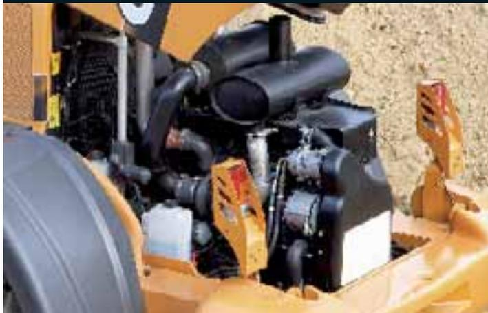
Le pale 721E e 821E sono entrambe azionate da un motore diesel Case 667TA/EED emisionato Tier III. Questo motore a controllo elettronico da 6700 cm<sup>3</sup> permette di scegliere fra 3 diversi livelli di potenza e di coppia, in modo da sfruttare al meglio le potenzialità della macchina in qualsiasi applicazione, riducendo al minimo il consumo di carburante.
