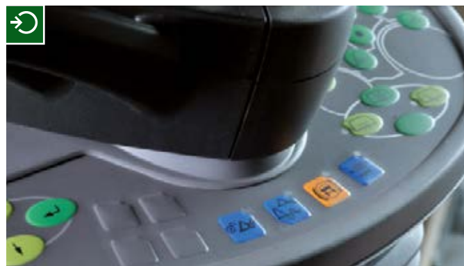
Pulsadores de membrana para bloquear los accesorios y para activar el sistema de amortiguación.
