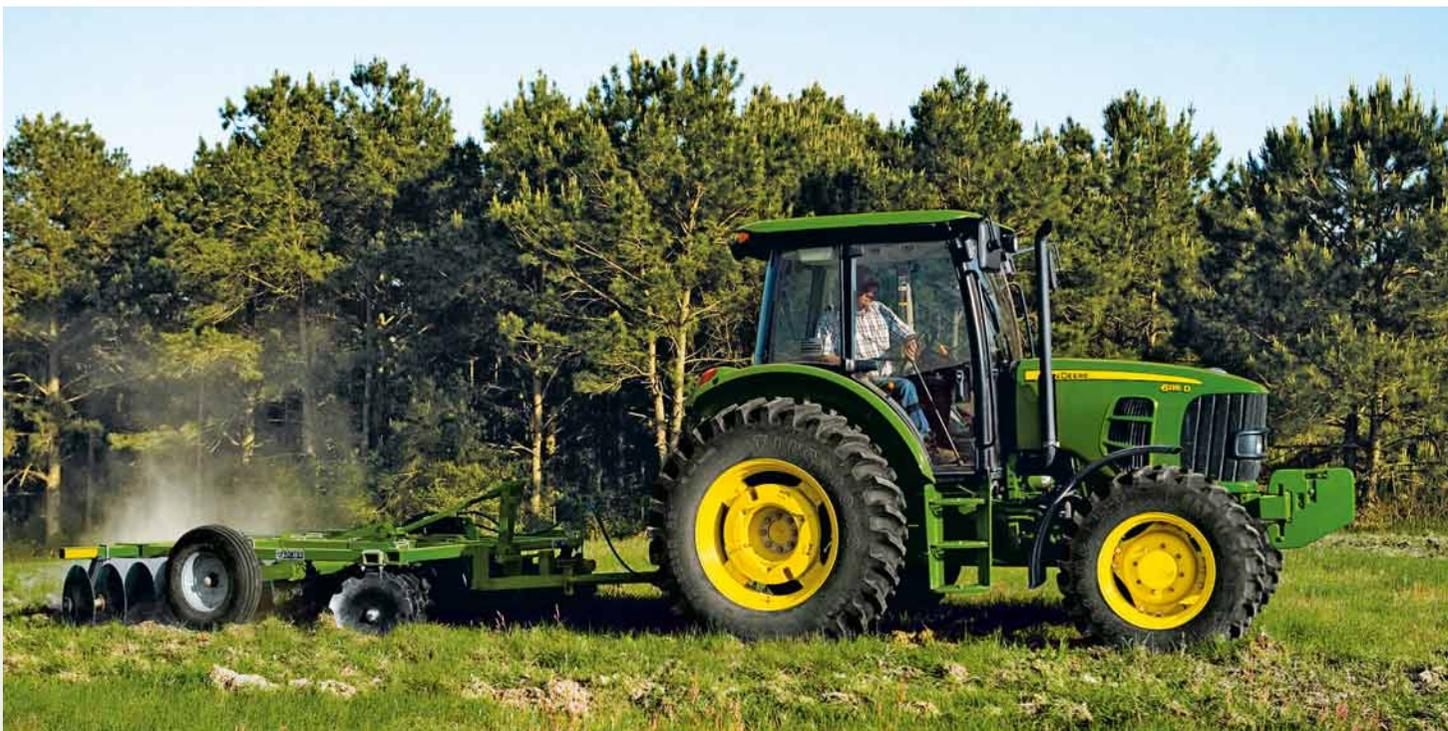
**Pont avant mécanique :** Les tracteurs 6D sont équipés d'un pont avant mécanique qui leur confère une excellente motricité et une remarquable puissance de traction. L'amélioration de la traction impliquant un lestage limité, vous bénéficiez également d'une compaction du sol réduite, de factures de carburant allégées et d'une longévité accrue des pneus.
