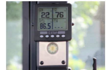
Neues Info-Display in der B-Säule für das Abgassystem (bei Ladern der 86er- und 96er-Serie)
