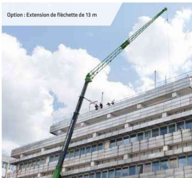
Flèche avec extension verrouillable sur le pied de flèche lorsqu'elle n'est pas utilisée
