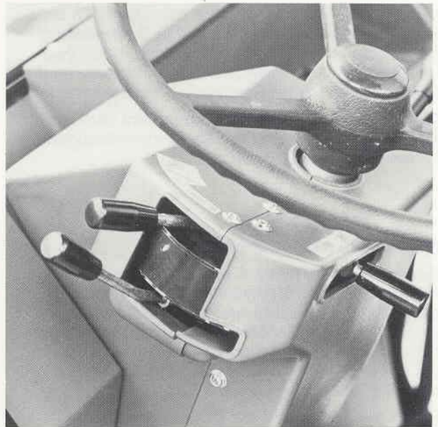
▲ Moderne, leichtgängige 2-Hebel-Tippschaltung
