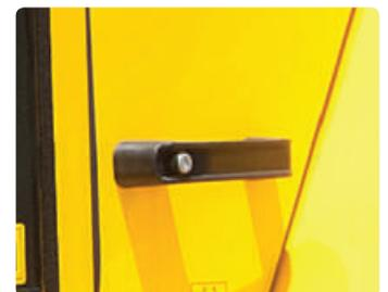
**Système de verrouillage de recouvrement d'aile**
