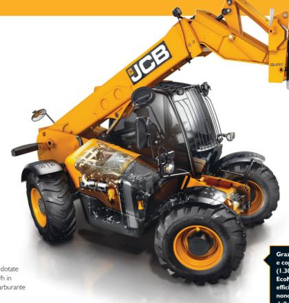
Grazie all'erogazione di potenza e coppia elevate anche a bassi regimi (1.300 - 1.400 giri/min), il motore EcoMAX garantisce una maggiore efficienza dei consumi di carburante, nonché un efficace utilizzo combinato della trasmissione e dell'impianto idraulico.
