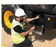
I filtri del movimentatore telescopico (olio motore, olio idraulico e carburante) sono posizionati centralmente per
