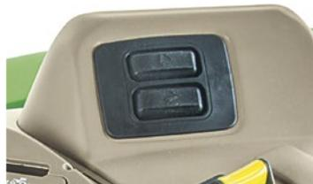
Il sistema di sollevamento elettrico ad abbassamento rapido (EQRL), ideale per le svolte a fine campo, permette di controllare senza sforzo gli attrezzi montati mentre il trattore è in movimento semplicemente agendo su un interruttore.
